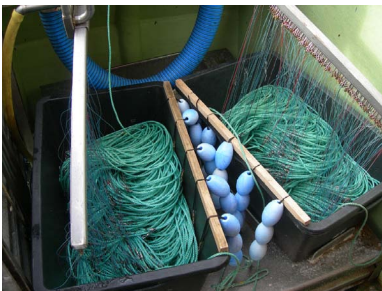
Abbildung 17: PVC-Auftriebskörper an zwei Hakenmagazine vor dem Setzen (Foto: NABU/K.Detloff)
