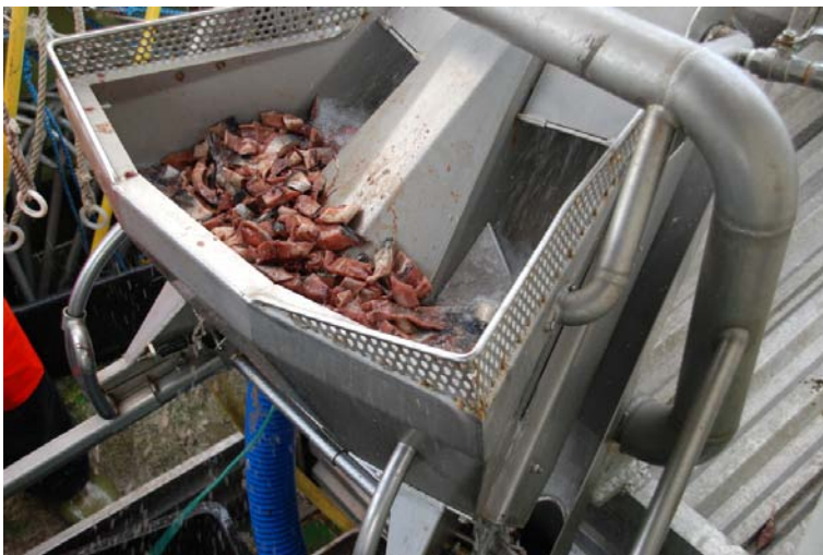
Abbildung 15: Geschnittene Heringe als Köderfisch im Oilwind Beköderer (Foto: NABU/K.Detloff)
